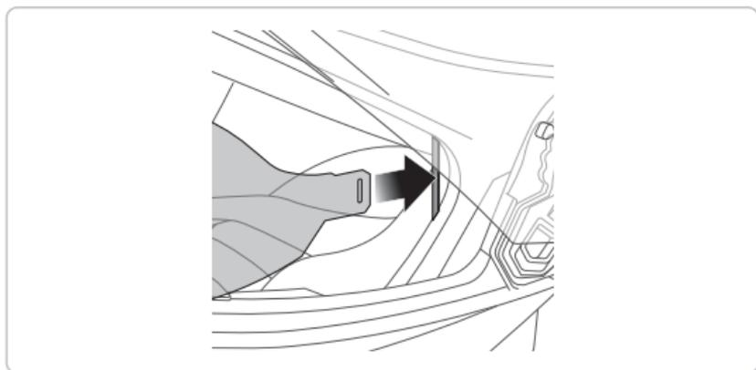
1. Setzen Sie den Steckverbinder in seine Aussparung ein und drücken Sie auf die Sonnenblende, bis Sie einen Klick hören.
