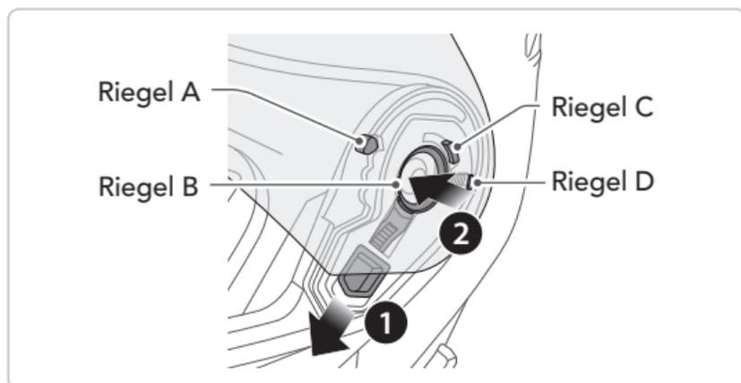
1. Richten Sie die Riegel A, B, C und D wie auf der Abbildung oben gezeigt am Visierraster aus.
