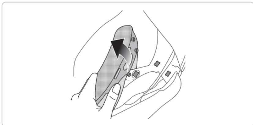
1. Öffnen Sie die 3 Druckknöpfe, mit der die Wangenpolsterung und der Helm verbunden sind.
