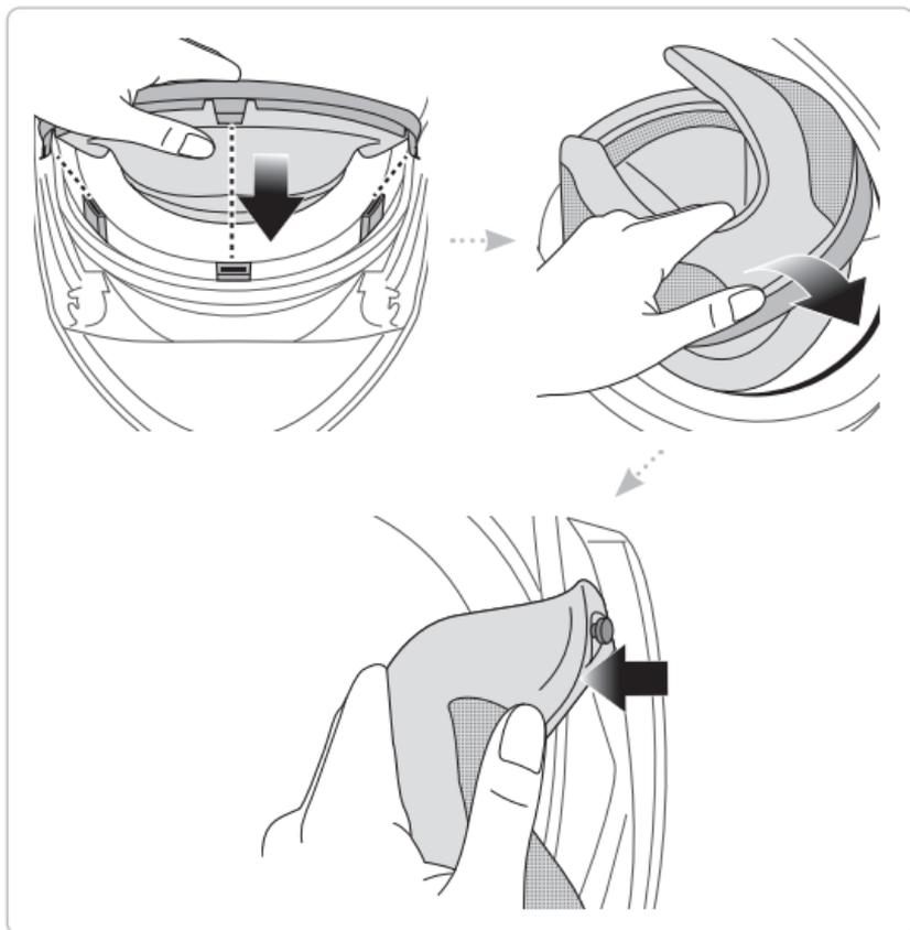
1. Setzen Sie die 3 Noppen der Innenpolsterung in die entsprechenden Aussparungen im vorderen Teil des Helms ein.
