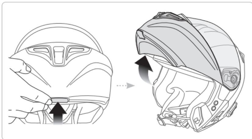
Ziehen Sie den Kinnschutzhebel nach außen und heben Sie den Kinnschutz so weit wie möglich an.
