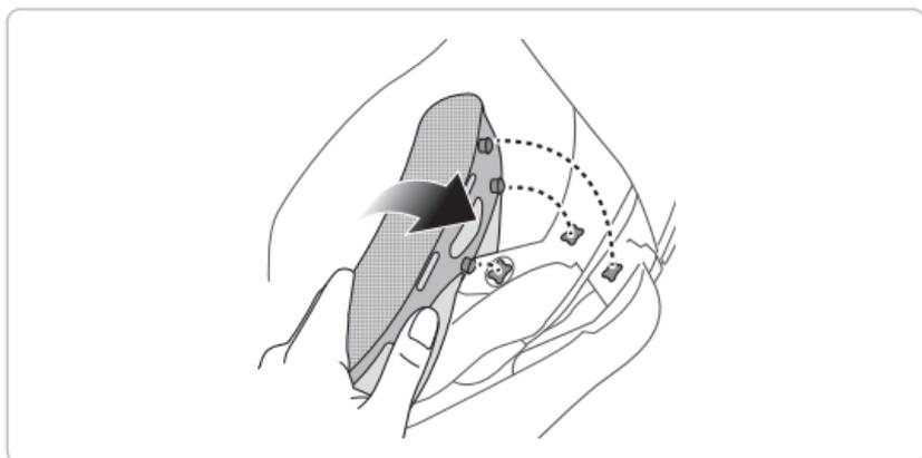
1. Ziehen Sie den Kinnriemen durch das Loch in der Wangenpolsterung und befestigen Sie die Wangenpolsterung mithilfe der 3 Druckknöpfe.
