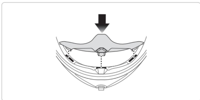
Setzen Sie die 3 Noppen des Atenschutzes in die entsprechenden Aussparungen ein.
