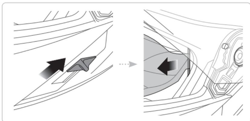
1. Schieben Sie den Hebel für die Sonnenblende in die Richtung, die auf der Abbildung oben gezeigt wird, damit sich die Sonnenblende senkt.
