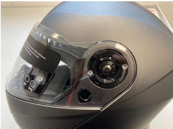
2. Öffnen Sie das Visier. Der Haltepin muss auf der Höhe des Hebels der Visiermechanik sein.
