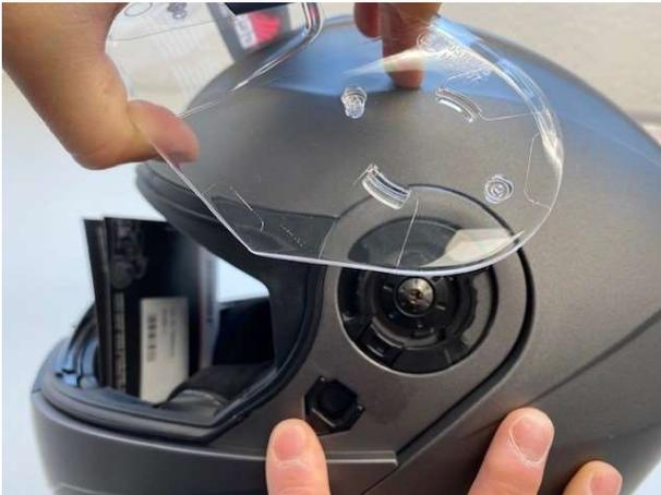
5. Beim Einbauen des Visiers, sollte der obere Pin zuerst in die Schiene gedrückt werden.
